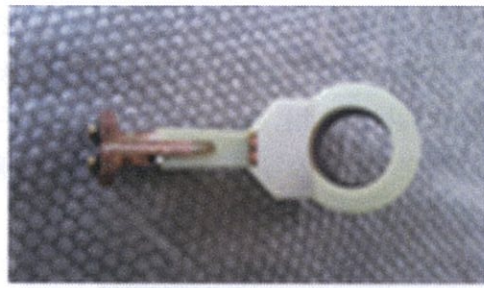
写真一5 ボルトナット用加熱ヘッド
